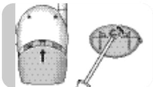
3 Schuif het klepje van het batterijvak (B-11) weer op zijn plaats tot het vastklikt en sluit het vak met behulp van een schroevendraaier.
